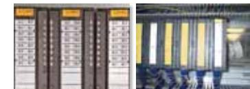
Tarjetas para PLC Siemens SIMATIC S7-300 y ET 200S, sustituyen las tarjetas neutras suministradas con el mecanismo.
