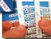
La lámina impresa se divide en espinas doblando y cortando los extremos de unión.
