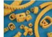
Los anillos de señalización **RMS** están disponibles en cuatro medidas para el marcado de conductores con un diámetro exterior comprendido entre 1,3 y 16,0 mm; con coloración del fondo en amarillo e impresión del carácter en negro, o bien con la codificación internacional IEC 757, para las versiones numerales o sin impresión.
